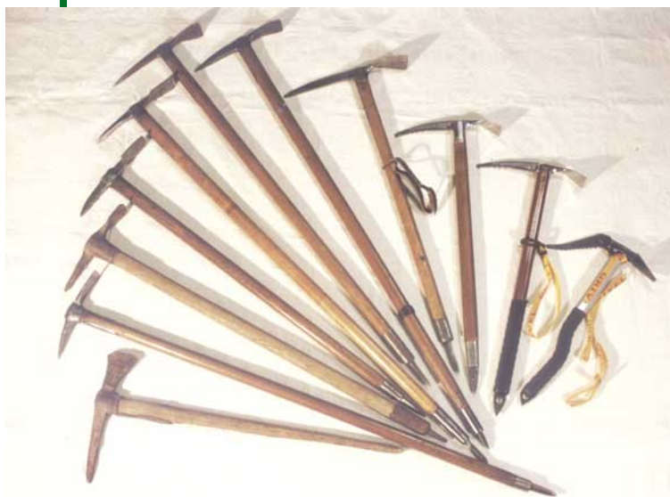
Sopra: dalla lama verticale alla lama "a banana": un secolo e mezzo di evoluzione della piccozza.
